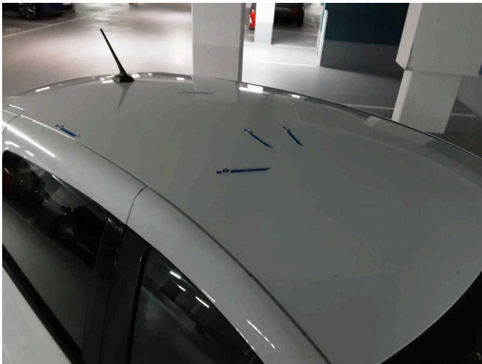
Beschädigung 3: Fahrzeugdach: Dach (5 Dellen) - Delle(n) - sanft instandsetzen
