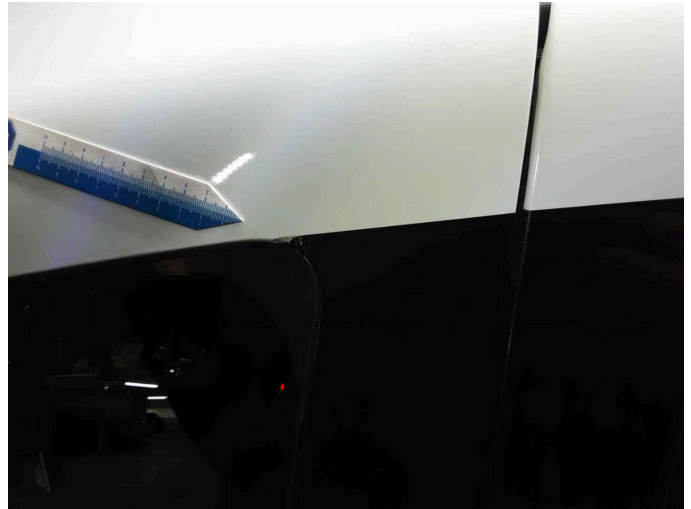
Beschädigung 2: Tür vorn links: Tür (Folierung) - beschädigt - erneuern
