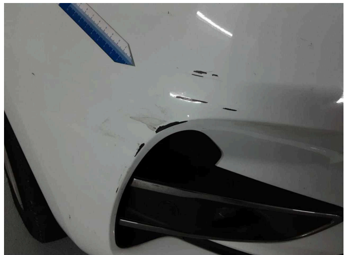
Beschädigung 5: Stossfänger vorn: Stossfänger vorn - verkratzt / verschürft - lackieren
