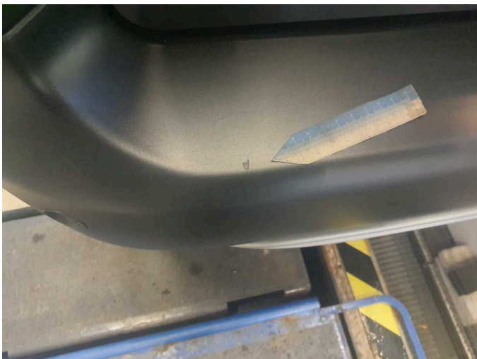
Gebrauchsspur 1: Stossfänger hinten: Stossfänger hinten - Kratzer - kein Abzug
