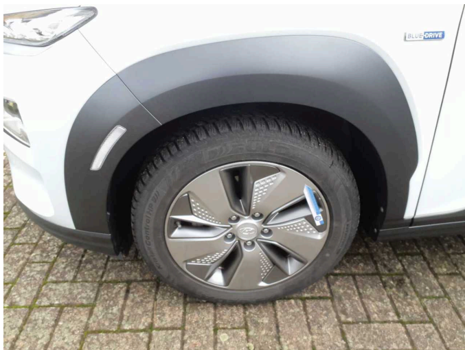
Beschädigung 2: Rad/Reifen: Leichtmetallfelge vorn links (optische Beeinträchtigung) - verkratzt / verschürft - Wertminderung
