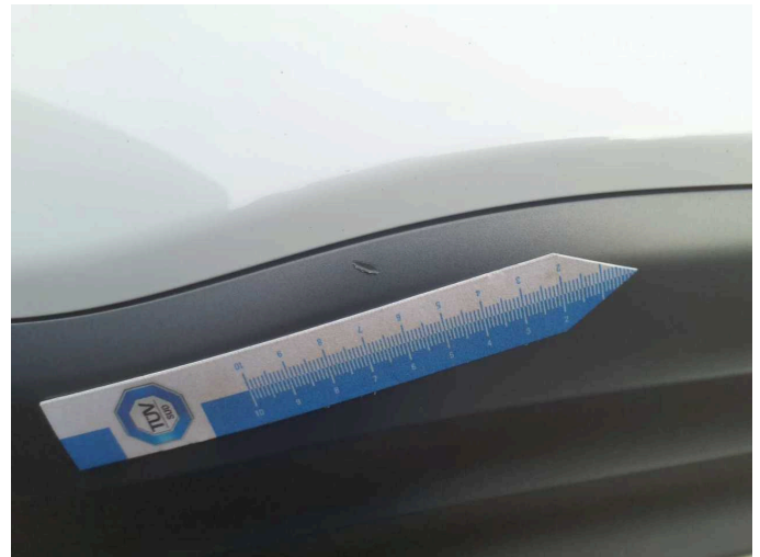
Beschädigung 1: Stossfänger hinten: Spoiler - verkratzt / verschürft - Wertminderung
