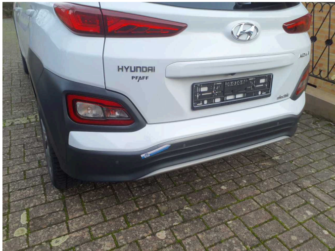
Beschädigung 1: Stossfänger hinten: Spoiler - verkratzt / verschürft - Wertminderung
